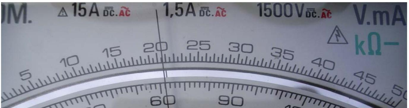
Sur le calibre 50 V, on constate qu'il y a une erreur de parallaxe, l'aiguille ne coïncidant pas avec son reflet dans le miroir lors de la lecture.
