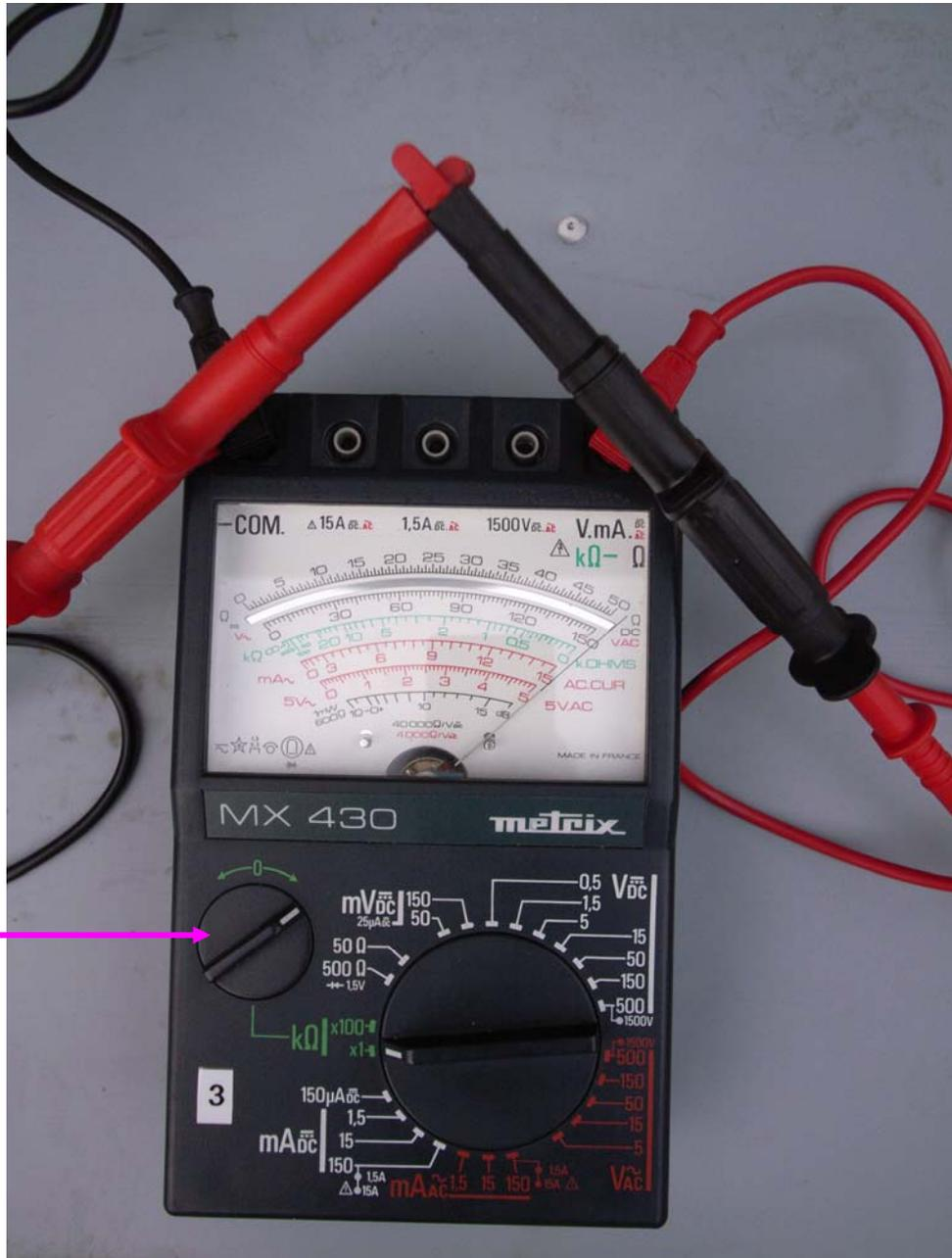
Il est important de savoir que pour cette fonction, le courant de mesure sort par la borne **COM** et rentre par la borne  $\Omega$ . Cela est important dans le cas où l'on veut tester des transistors bipolaires (PNP ou NPN) ainsi que des diodes.
