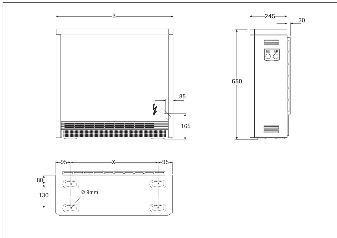
Het plaatsen en de elektrische aansluiting moeten, met in acht neming van de montagehandleiding, door een vakman worden uitgevoerd.
