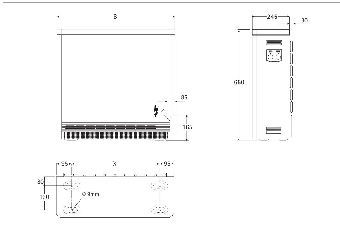
L'installation et le raccordement électrique doivent être effectués par un spécialiste conformément aux présentes instructions de montage.
