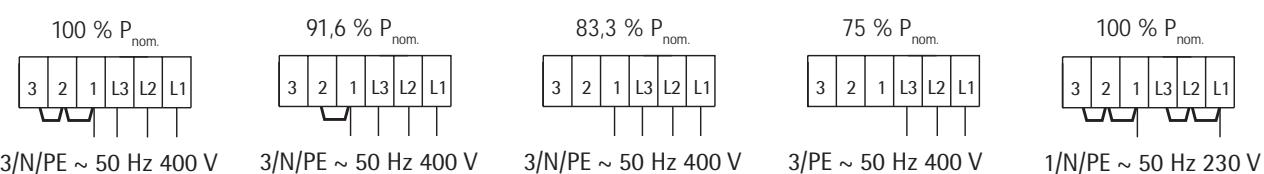
Schéma des raccordements pour la Belgique et la France
