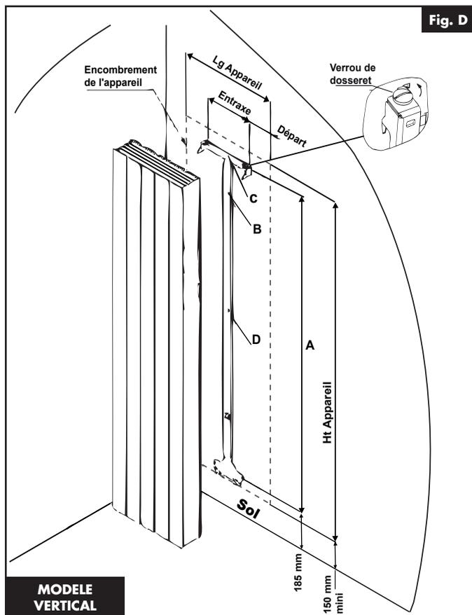
■ Déverrouiller le dossieret en agissant à l'aide d'un tournevis sur les verrous dans le sens des aiguilles d'une montre puis ôter le dossieret de l'appareil (Fig.D).
