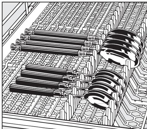
Lorsque les cuillères ne peuvent être insérées entre les supports, placez les de sorte que les poignées reposent sur les supports dentelés.
