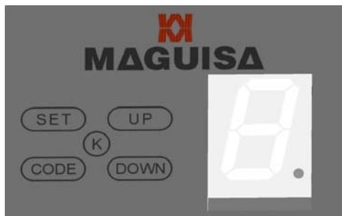
Appuyez sur le bouton « CODE » jusqu'à ce qu'apparaisse le point allumé
