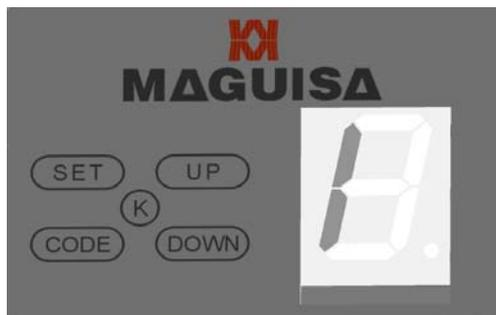
Maintenez appuyé le bouton « SET » jusqu'à ce qu'apparaisse le chiffre 1.
