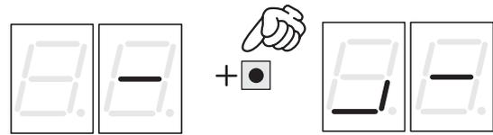
Pour que l'automatisme puisse fonctionner correctement, l'état des segments du caractère de gauche doit correspondre aux indications de l'image ci-contre, correspondant à la situation d'automatisme au repos et sans générateurs d'impulsion ni sécurités engagées.
