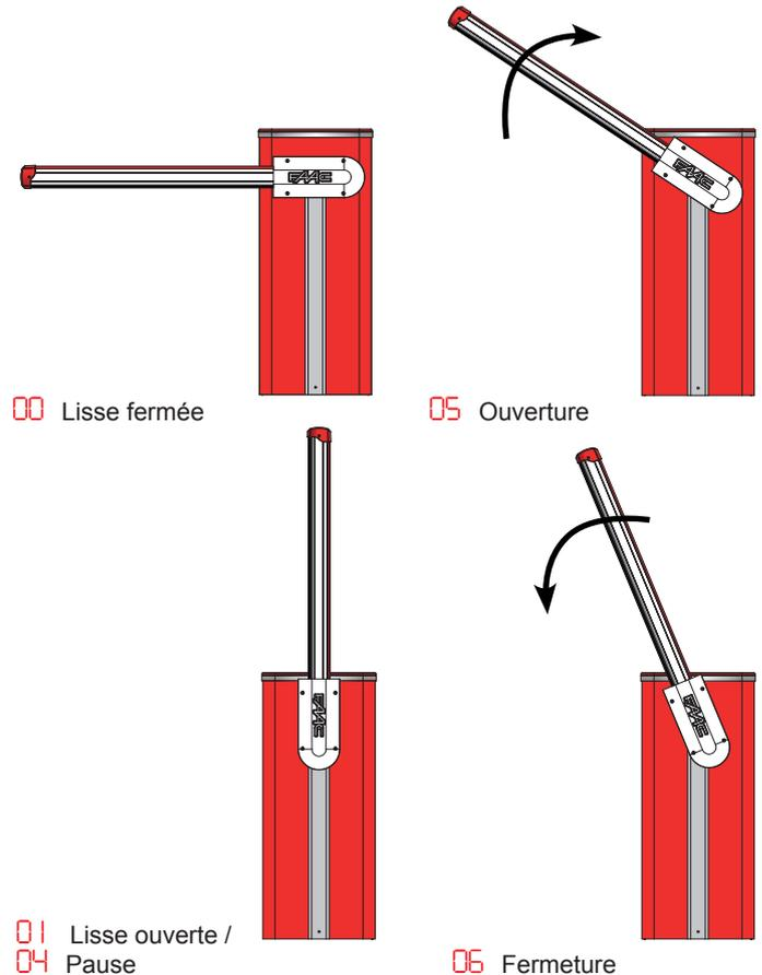
La séquence n'indique pas les états **09** et **10** qui correspondent respectivement au préclignotement en ouverture et en fermeture.
