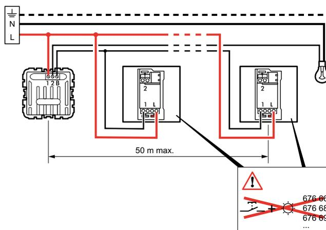
**Important:** Si l'installation comporte déjà un «circuit» télérupteur avec boutons-poussoirs, on ne peut pas placer un variateur 670 82.
