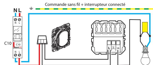
Utilisez un **connecteur** pour raccorder ensemble les 3 fils (navettes 1, 2 et retour de lampe). Utiliser un connecteur séparé pour isoler le fil du neutre (si présent).
