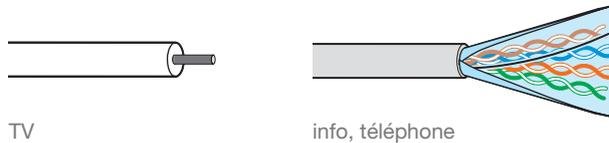
**TV** un câble coaxial est capable d'acheminer les signaux terrestres, câbles et satellites
