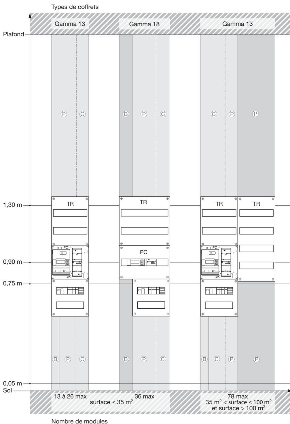
Ⓑ - goulotte ou compartiment de goulotte «branchement» qui doit être continu au moins jusqu'au panneau de contrôle
