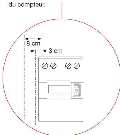
Exemple : si le bac d'encastrement est composé de parois métalliques, le panneau de contrôle doit être positionné afin de respecter une distance de 8 cm entre les parois du bac d'encastrement et les bornes du compteur. Grâce à l'accessoire d'isolation réf. GZ49A il est possible de réduire cette distance à 3 cm.
