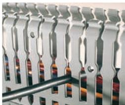
Les goulottes Segma possèdent des languettes dont les têtes sont rendues non blessantes. L'espace entre 2 languettes est de 6 mm, ce qui permet le passage d'un fil de section 6 mm<sup>2</sup> maxi, sans casse de la languette.
