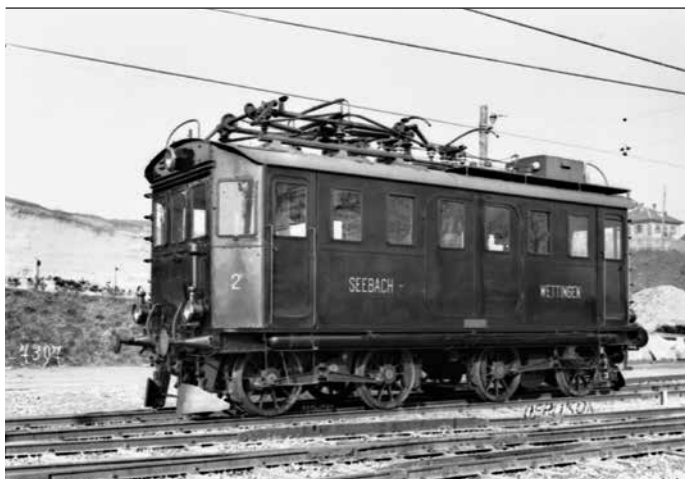
4 Seconde locomotive d'essai Oerlikon à moteurs monophasés (1905)
