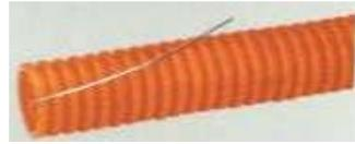
Fig. 12 - Conduit ICTA de couleur orange (propagateur de la flamme), ce conduit n'est pas admis en montage apparent.
