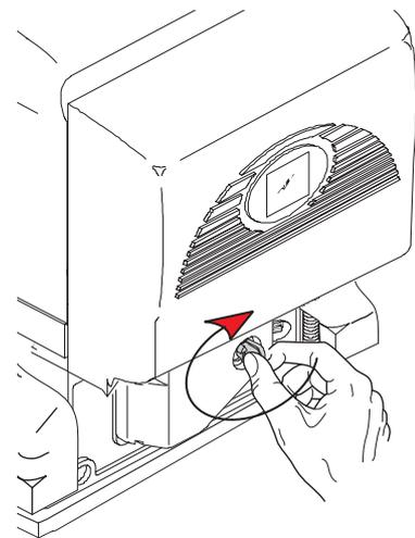
..... ouvrez le volet et tournez la poignée de déverrouillage dans le sens contraire aux aiguilles d'une montre.
