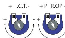
**Trimmer A.C.T.** = Il règle la durée de l'attente en position d'ouverture. Lorsque ce délai est écoulé, la manœuvre de fermeture s'effectue automatiquement. La durée du temps d'attente peut être fixée de 1 à 120 secondes.
