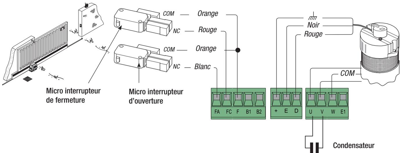
Modifications des connexions électriques pour installation à droite
