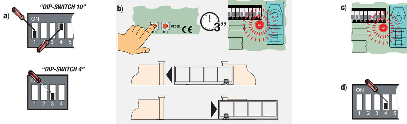
La **vitesse de marche ralentie** peut être changée simplement en appuyant sur **CH1 (pour la diminuer)** ou **CH2 (pour l'augmenter)** pendant que l'automatisme est en phase de ralentissement.
