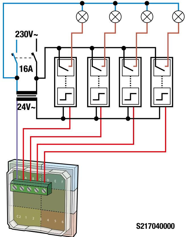
2 verschillende lichtkringen van op 1 plaats bedienen: 1= zonder feedback, 2= met feedback
