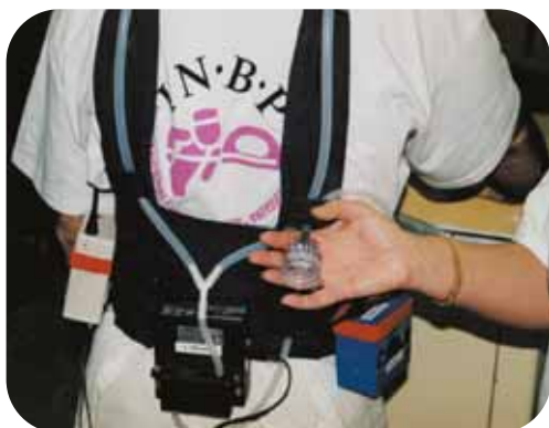
L'équipement : une pompe de prélèvement (bleue), un compteur de particules (noir), un double tuyau qui part du compteur pour être positionné à hauteur du nez
