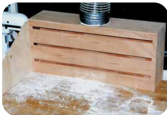
Caisson de captage localisé situé sur la table de travail pour les opérations de fleurage
