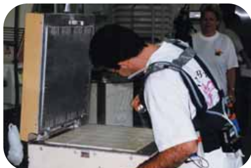
Pulvérisation d'huile sur le plateau de la diviseuse
